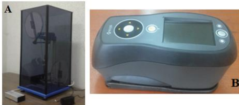
Şekil 2. Salınımsal sertlik ölçüm cihazı (Model 299/300 Erichsen) (A) ve Renk ölçüm cihazı (Model X-Rite Ci62) (B)
